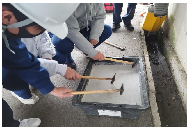
コンクリート調査 (空洞のある不良コンクリート塊の打音調査)
