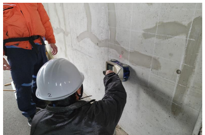
コンクリート調査 (RCLレーダーによる鉄筋探査)
