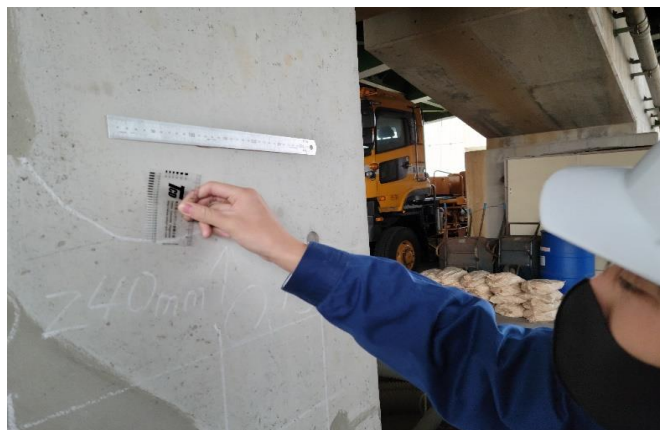
コンクリート調査 (クラックスケールによるひび割れ幅測定)
