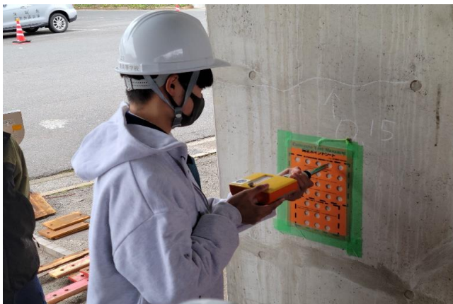
コンクリート調査 (シュミットハンマーによるコンクリート強度推定)
